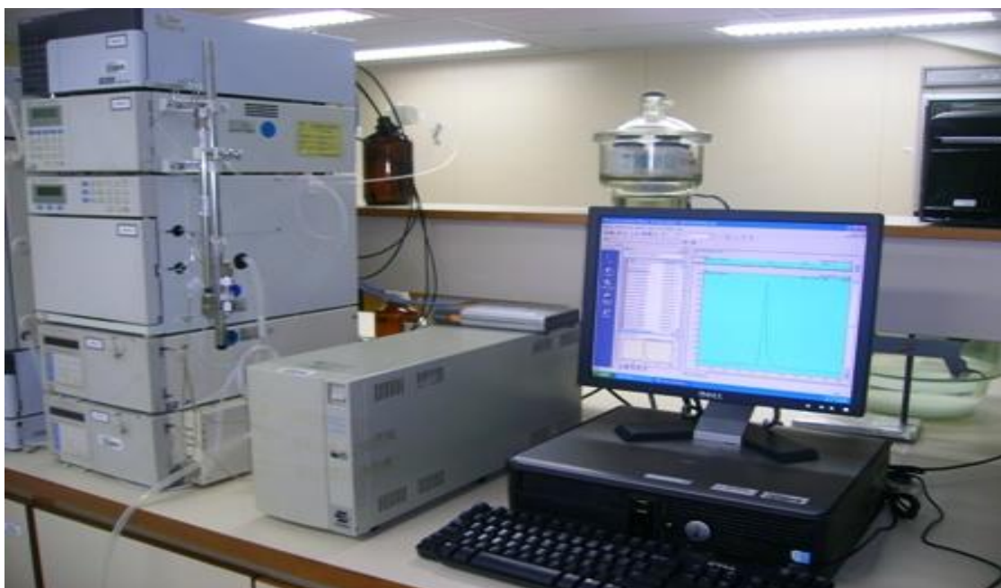
Figura 3- Cromatógrafo líquido, com detector ultravioleta-visível (Shimadzu) completo usado em todos os requisitos da validação.
