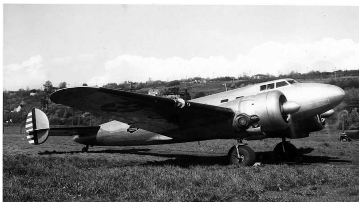
Figura 54- O Lockheed XC-35 era um avião característica de pressurização na cabine (1939). Fonte: acervo do autor (2002)
