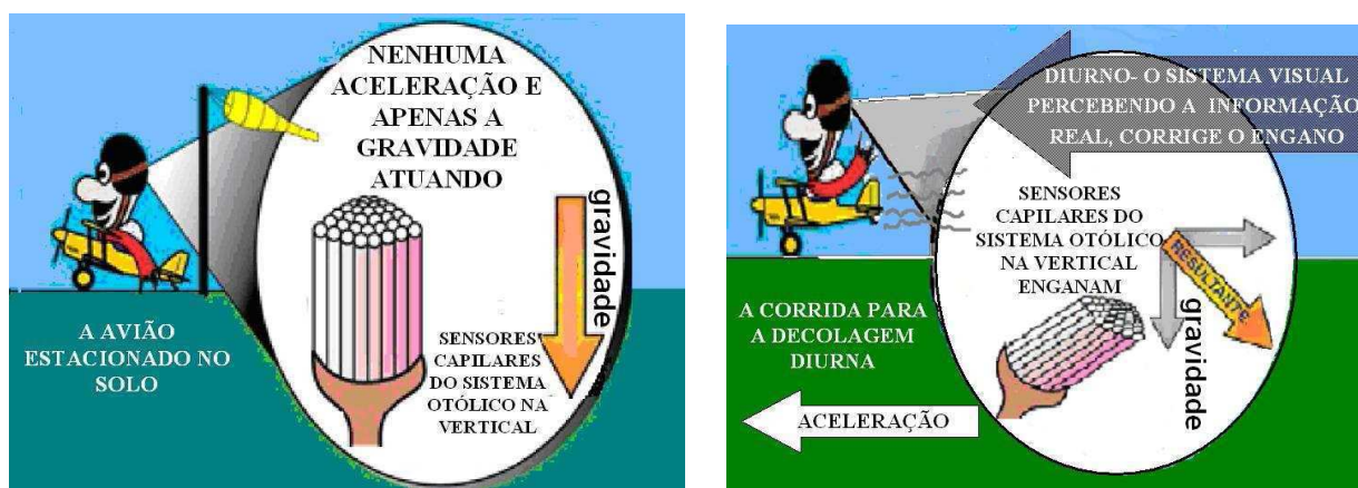
Figura 39a- A força resultante enquanto a aeronave está no solo e parada. Os otólitos e os olhos indicam corretamente o sentido e a posição real da cabeça. (Sem a ação da aceleração linear) e Figura 39b- A força resultante durante a rolagem no solo (gravidade e aceleração em linha reta). A informação visual substitui os sinais incorretos otólitos
