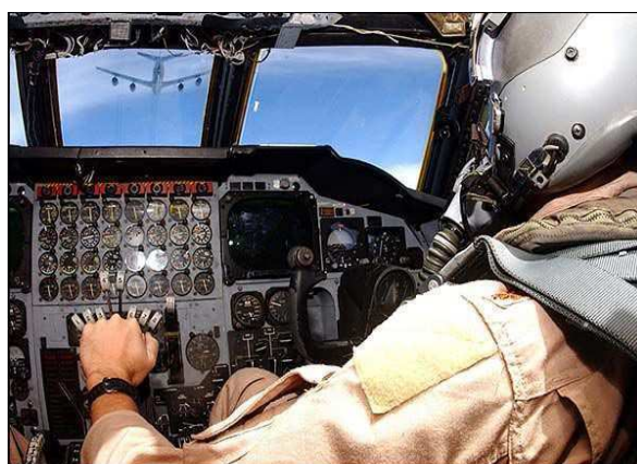
Figura 102- A complexa interface de controle do Boeing B-52 e seus 8 motores. Fonte : Disponibilizada por Maryland Aviation Museum autorizada (2005)
