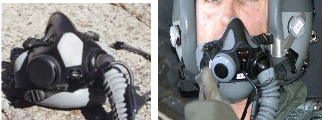
Figura 58 - Uma máscara de uso militar com o sistema MSOGS- Geração molecular de Oxigênio Fonte: E.U. Naval Air Development Centre,(2008)
