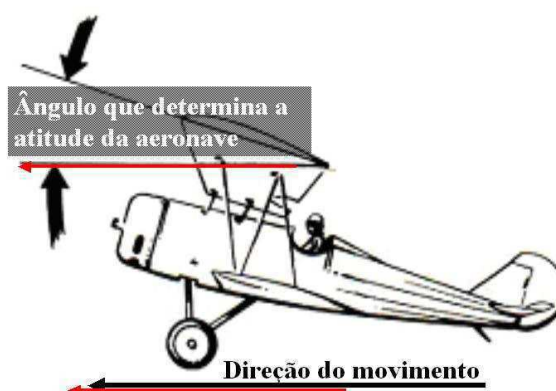
Figura 41- A atitude da aeronave- o ângulo entre a direção e seu eixo longitudinal
