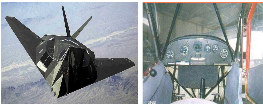
Figura 32a e 32b Visões frontais limitadas do F-117 devido ao formato aerodinâmico e do antigo treinador básico civil Neiva Paulistinha P-56 quando em terra (ponto de vista do piloto) Fonte: acervo do autor (2008)
