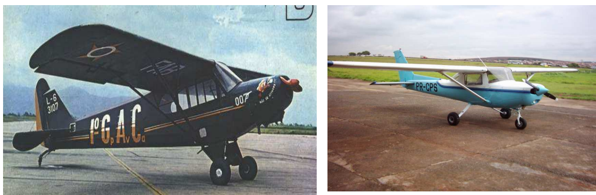
Figuras 110a e 110b- Modelos com trem de pouso convencional (Paulistinha P-56) e com bequilha frontal (Cessna 150).
