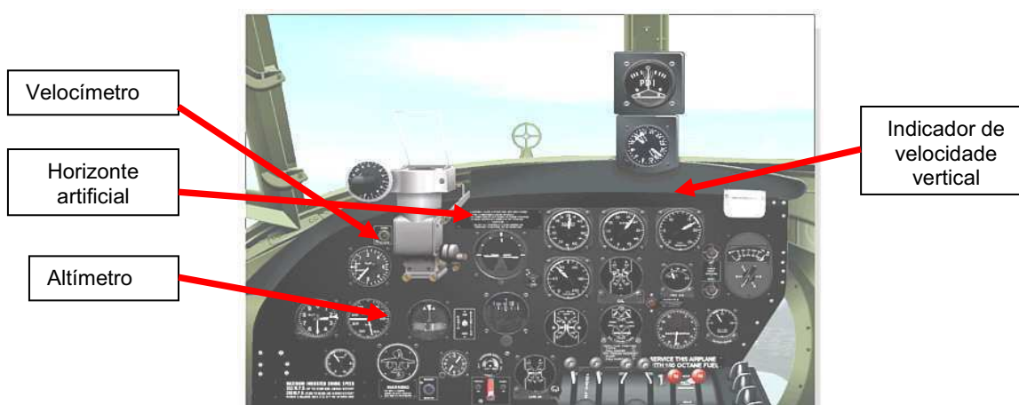
Figura 42- O indicador de atitude (horizonte artificial), o altímetro e do indicador de velocidade vertical ( Vertical Speed Indicator )
