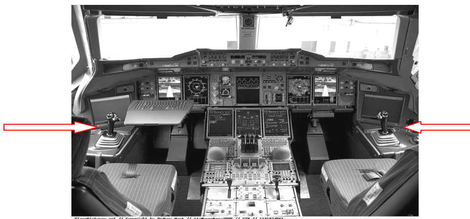
Figura 80- O cockpit do Airbus A-380 - Glass and Paperless cockpit além dos “Sticks” de comando. Fonte: Cedida pelo piloto Marco Antonio Rocky (2006)
