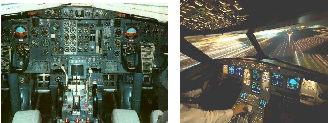
Figuras 68a e 68 b- Gerações diferentes de aviões: Interfaces analógicas, codificadas e interfaces digitais orientadas a objeto.
