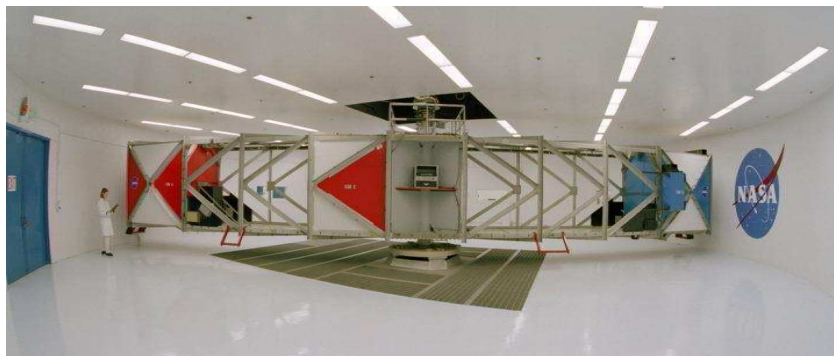
Figura 21 - Centrífugas humanas são excepcionalmente grandes para testar as reações e tolerância de pilotos e astronautas com aceleração acima dos sentidos na gravidade da Terra Fonte: acervo do autor (2006).
