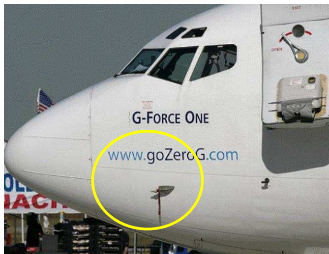
Figura 93- A sonda do tubo de pitot com um protetor. Nota-se a tira vermelha que alerta a sua presença e que deve ser retirada nos procedimentos de preparação para um voo.
