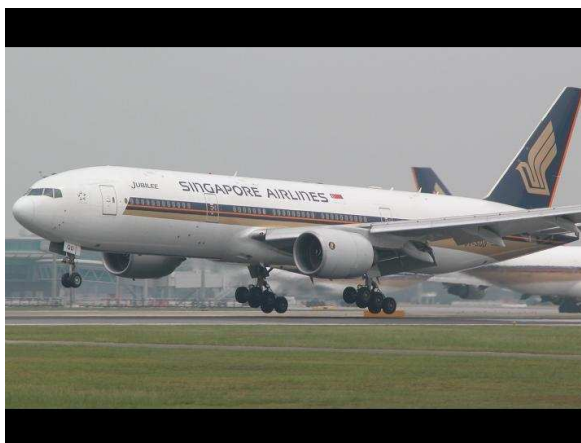
Figura 119- As rodas prontas para o toque em terra- O trem de pouso baixado e travado Fonte: foto do acervo do autor (2008)
