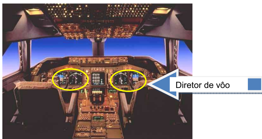
Figura 66- Representação do painel do Boeing 747 com os DV em destaque. Fonte: America Aviation, Fla, USA, (2005).
