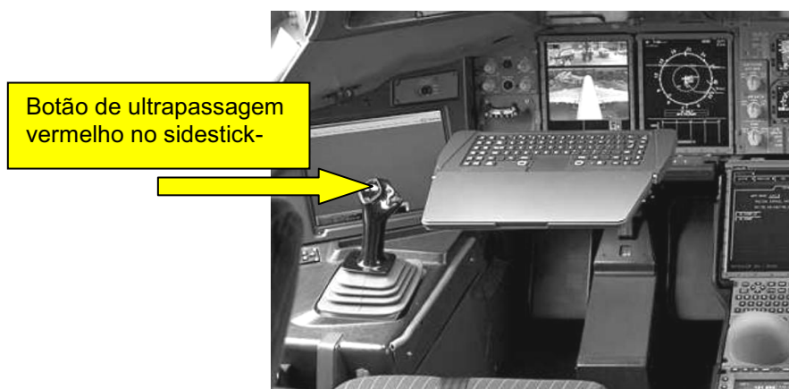
Fig- 90- Sidestick do piloto comandante no Airbus A380 - ao lado esquerdo do assento. Fonte: Foto cedida pelo Cmte Rocky, (2005)
