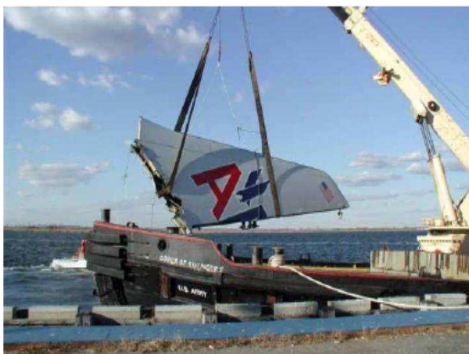
Figura 115- Separação da cauda de um Airbus A-300. Fonte: Foto do National Transport Safety Board , autorizada (2006)
