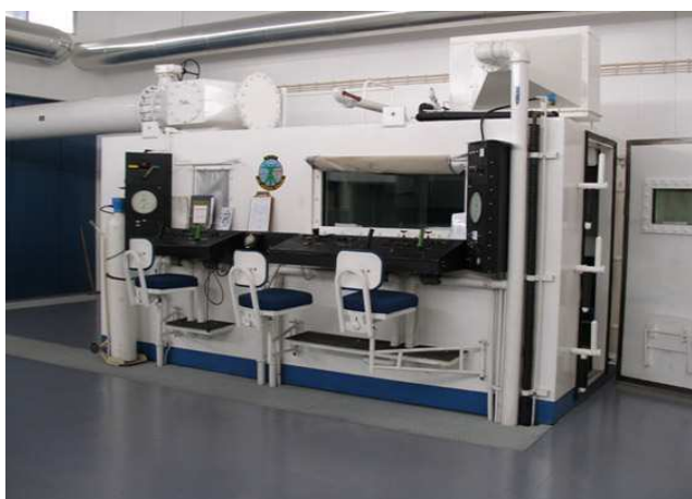
Figura 59- Uma câmara hipobárica, que tem a função de diminuir a pressão atmosférica. Fonte: E.U. Naval Air Development Centre,(2008)
