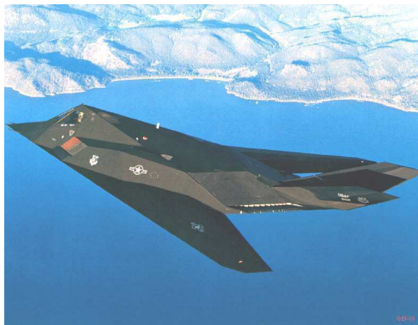
Figuras 86 A visão frontal é limitada no F-117 devido ao formato aerodinâmico. Fonte: Acervo do autor(2001)
