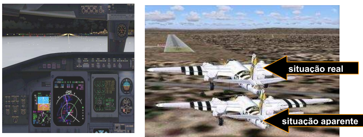
Figura 33a- Erro de julgamento no pouso e Figura 33b o efeito ilusório durante o dia - ( parallax-slope ) Fonte: figuras montadas pelo autor (2005)
