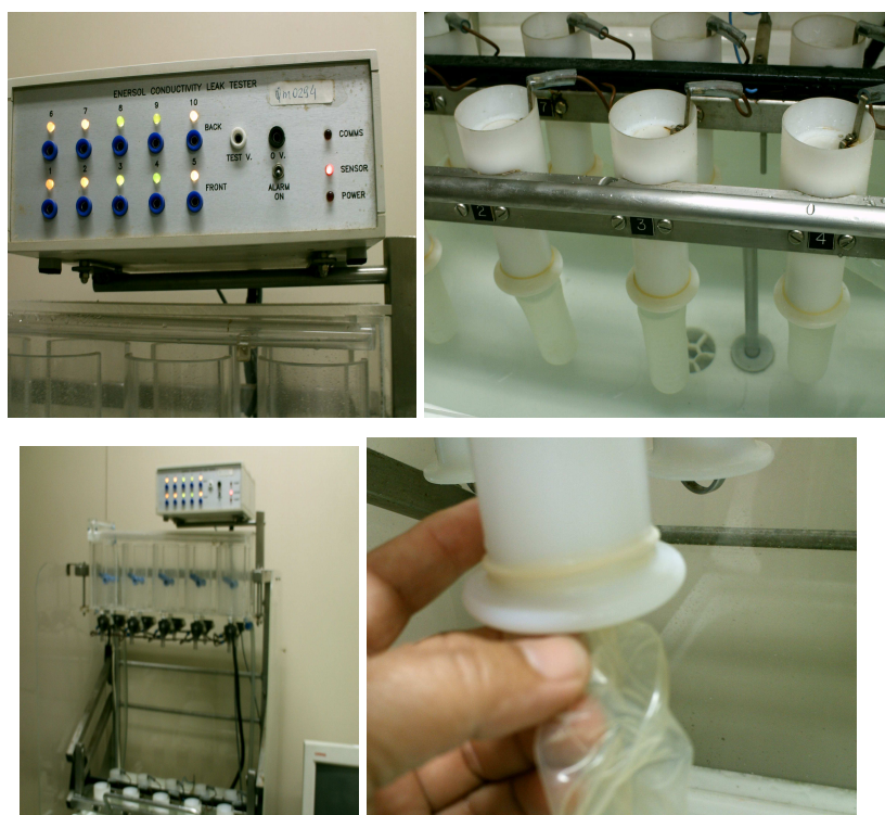
Figura 9 - Equipamento para verificação de orifícios (método elétrico)
