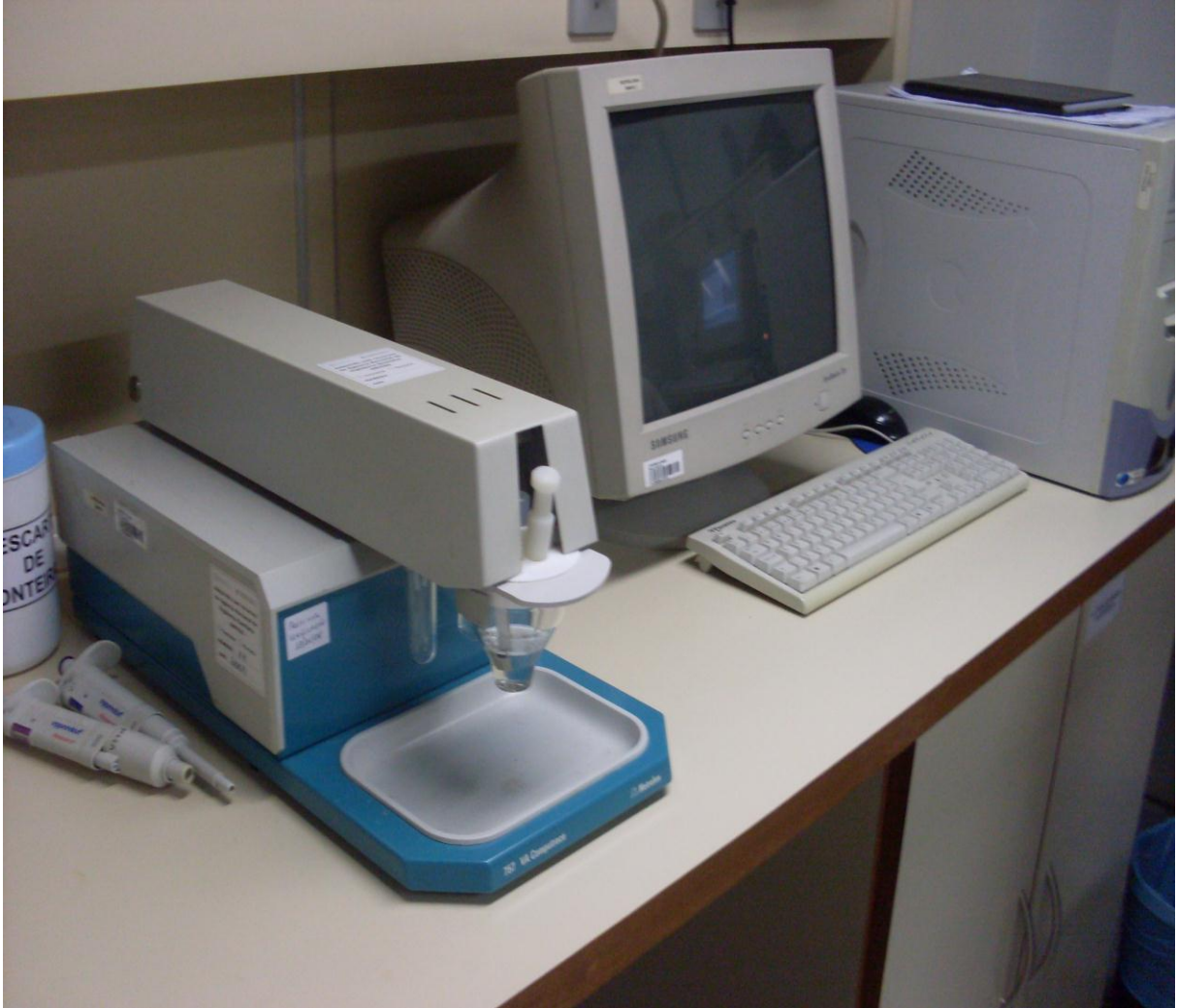
Figura 5- Sistema voltamétrico 757VA Computrace, fabricante Metrohm utilizado para analisar o teor de ácido valpróico em cápsulas de 250 mg pelo método de voltametria de pulso diferencial.
