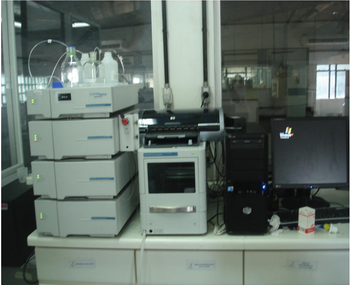
Figura 3 - Cromatógrafo Líquido, fabricante Young Lin, com detector espectrofotométrico de ultravioleta-visível com detector de arranjo de diodos (DAD) utilizado para a avaliação de todas as figuras de mérito da validação.
