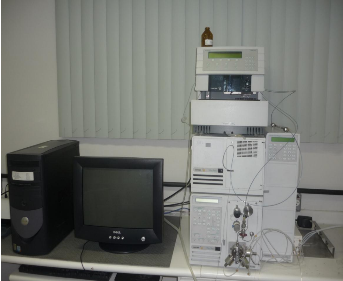
Figura 4- Cromatógrafo Líquido, fabricante Varian, com detector espectrofotométrico de ultravioleta-visível utilizado para a avaliação do requisito precisão intermediária.
