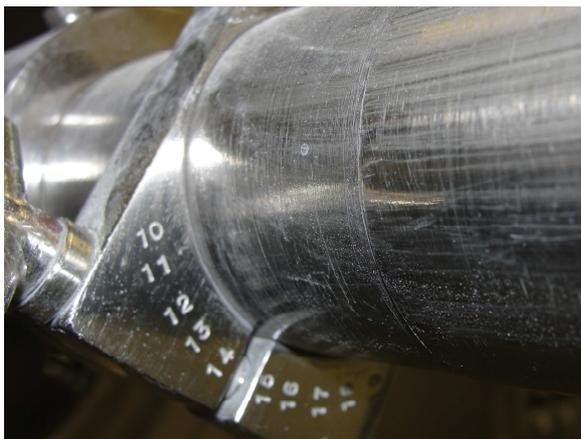
Figura 19: Círculo numerado para ajuste das pistolas em posição que permita a pulverização da suspensão sobre a metade superior do leito de comprimidos
