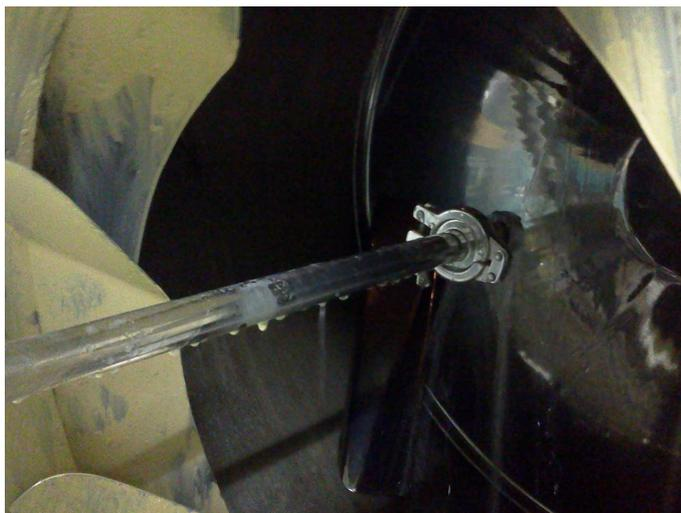
Figura 12: Braço com *spray ball* utilizado para limpeza interna do tambor do Eurovent
