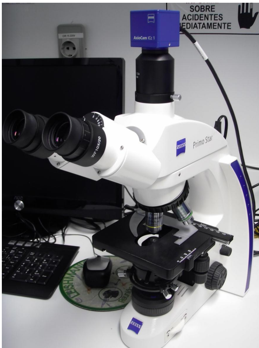
Figura 3.5 – Microscópio óptico Primo Star Marca Zeiss® acoplado com câmera AxioCam ICc1.
