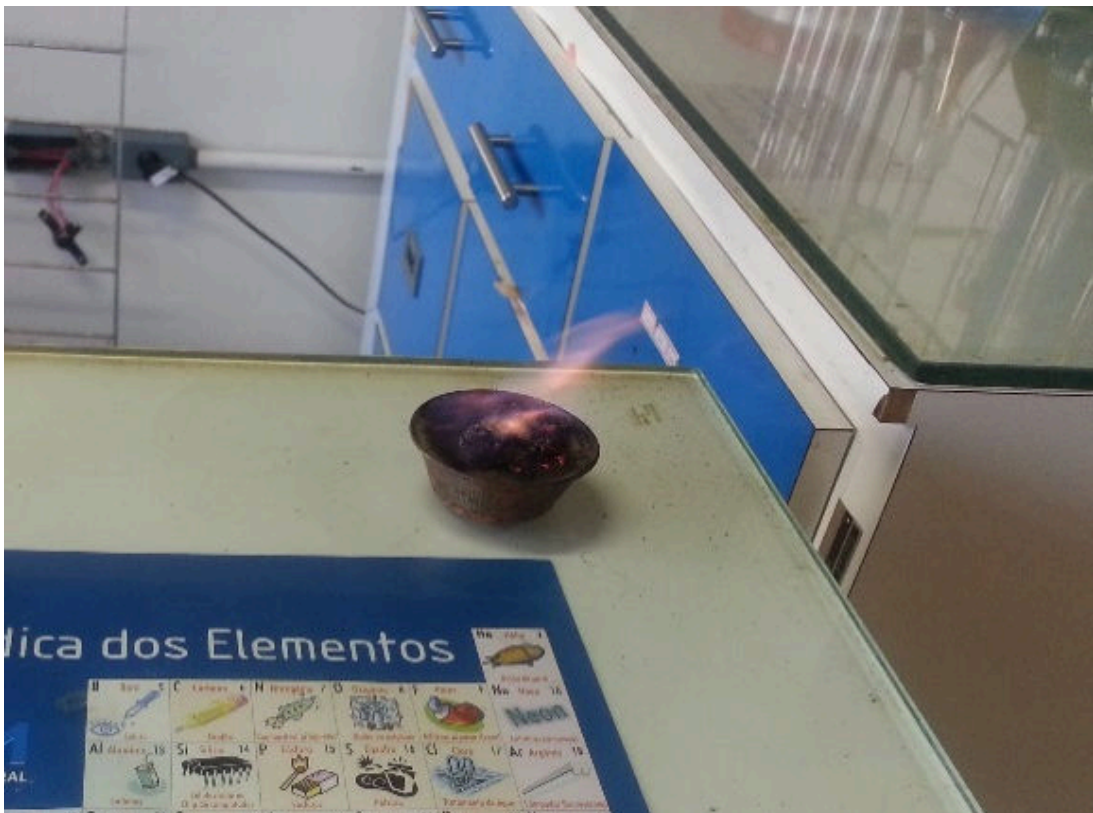
Figura 27 – Observação de campo: Experimento de combustão espontânea de Permanganato de Potássio e Glicerina, realizado por mediador da Casa da Descoberta
