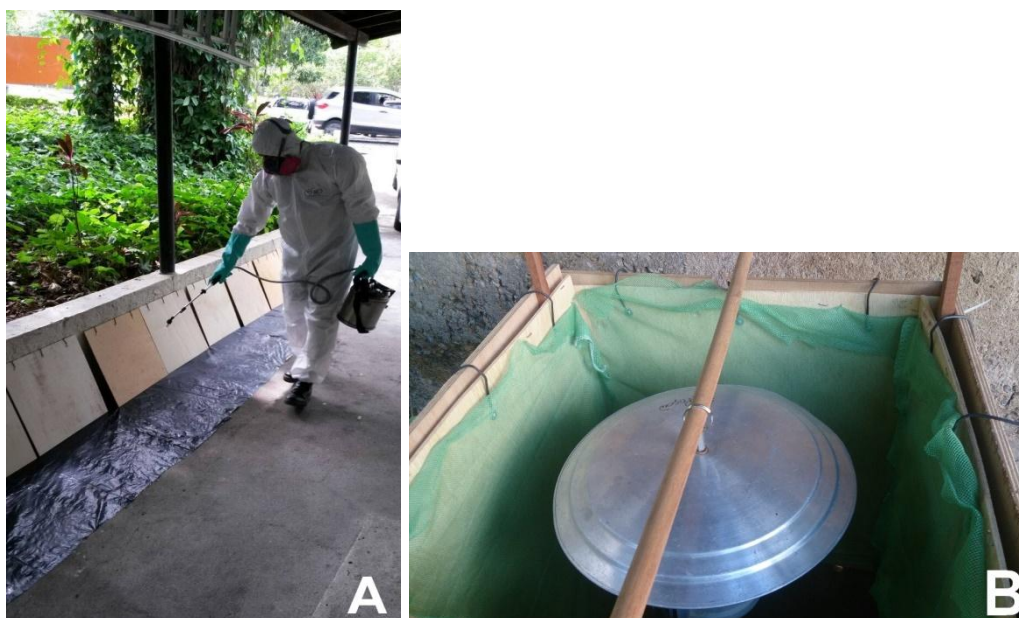
Figura 3.3: Borrifação (A) e Mosquiteiro (B) aplicados nos painéis de madeira. Fonte: Vanessa Barbosa.
