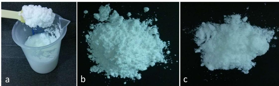
Figura 10. Aspecto das amostras: a) amostra TX2 logo após o preparo; b) matéria-prima; c) amostra TX7 após secagem.
