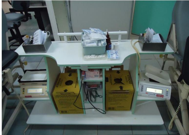
Fig.8: Protótipo da mesa de coleta de sangue com os homogeneizadores atuais.
