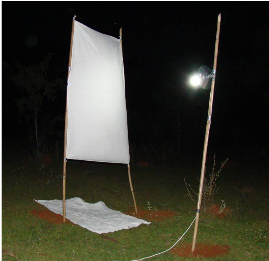
Figura 11 – Armadilha luminosa para atração de triatomíneos
