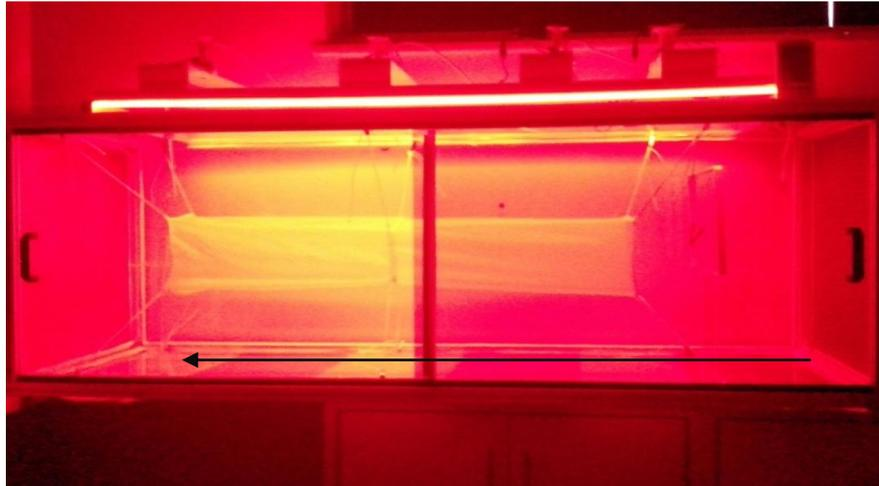
**Figura 10** - Condição de iluminação durante os testes no túnel de vento. Apenas a luz vermelha do túnel ligada. A seta preta indica a direção do fluxo de ar. Fonte: a autora.
