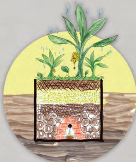
**O MÓDULO DE SANEAMENTO ECOLÓGICO** construído na Escola Municipal Martim de Sá, na Praia do Sono, é uma caixa de alvenaria selada/impermeabilizada, onde ocorre a decomposição anaeróbia da matéria orgânica, incorporando-a à sua biomassa e eliminando a água por evapotranspiração.
