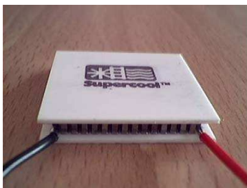
Figura 9: Foto de uma pastilha com efeito Peltier , semelhante a utilizada nos ensaios. Foto extraída do site: www.jaderfranca.com/blog/wp-content/uploads/2008/08/peltier4.jpg .
