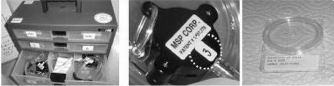
Retire la tapa del PEM y extraiga el impactador mediante la pinza anatómica. Limpie con papel extra suave de manera circular la parte superior del impactador retirando las partículas allí depositadas.
