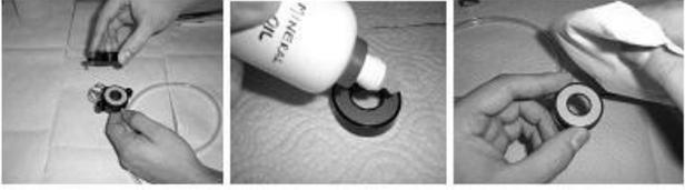
Abra el portafiltro y extraiga el filtro cuidadosamente con la pinza de examen desde su banda plástica. Deposítelo sobre la rejilla del PEM. Luego tome el impactador desde el borde y colóquelo sobre la rejilla. Tape el dispositivo. Nuevamente al atornillar, hágalo alternadamente en ambos extremos hasta que ajuste completamente.
