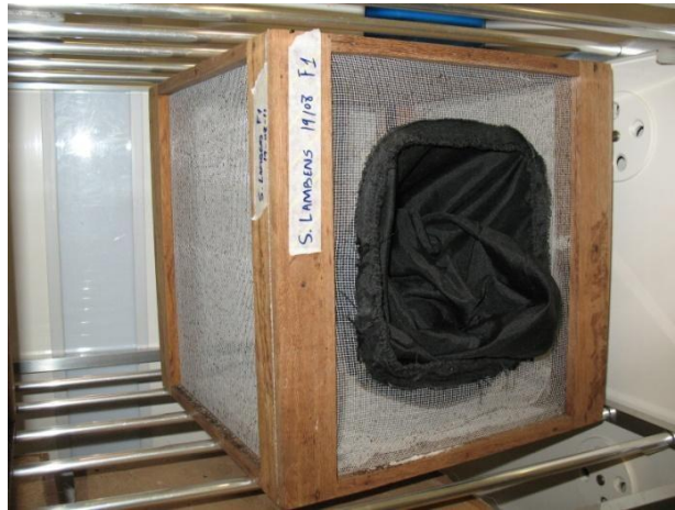
Figura 3.2 – Gaiola de madeira (30x30x30cm) telada utilizada para a criação em laboratório das espécies de díptero muscoides.
