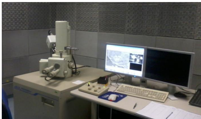
Figura 3.7 – Microscópio eletrônico de varredura Jeol JSM 6390LV da Plataforma de Microscopia Rudolf Barth do Instituto Oswaldo Cruz, FIOCRUZ.
