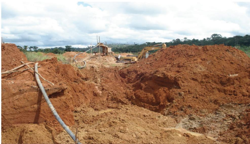
**Figura 2:** Extração do minério de cassiterita com lavra mecanizada
