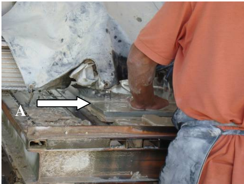
Figura 10: A) Posicionamento da pedra para o corte pela máquina.
