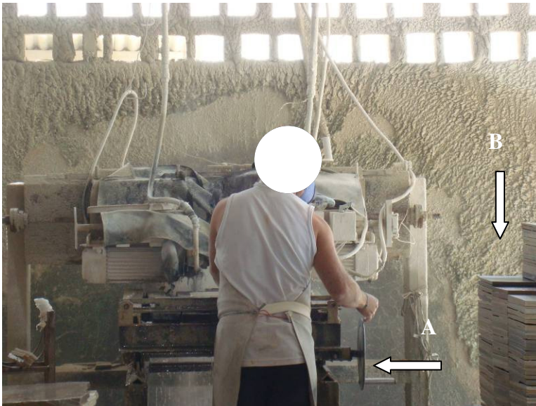
Figura 12: (A) Utilização da manivela para aproximar a pedra. (B) À direita da imagem pedras beneficiadas.
