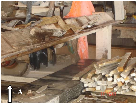
Figura 11: (A) Corte da pedra. Imagem aproximada.
