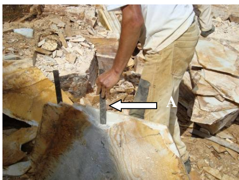
Figura 06: A) Utilização da chapinha para folhar a pedra
