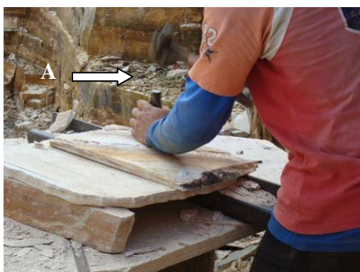
Figura 07: A) Utilização da talhadeira e marreta para corte manual da pedra.
