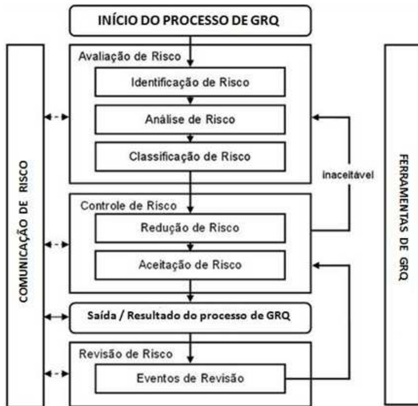
Figura 1-2 Visão geral de um típico processo de gerenciamento de risco da qualidade. (Extraído do ICH Q9, 2005).
