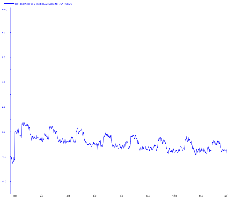
Figura 4.53: Cromatografia de exclusão molecular da solução PBS em coluna analítica TSK Gel G2500 SWxl (300 x 7,8 mm) 5µm equilibrada em solução tampão PBS pH6., fluxo de 1,0 mL/min, volume de injeção 100µL, pressão limite 10 mPa, detecção a 220nm.
