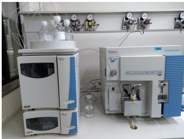
FIGURA 11. Foto do cromatógrafo em fase líquida, marca Thermo Scientific®, modelo Surveyor e o espectrômetro de massas com triplo quadrupolo, marca Thermo Scientific®, modelo TSQ Quantum, com software Xcalibur® utilizado na análise do S-PMA.
