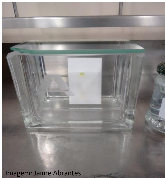
FIGURA 5 - Cuba com a placa em eluição na CCD.
