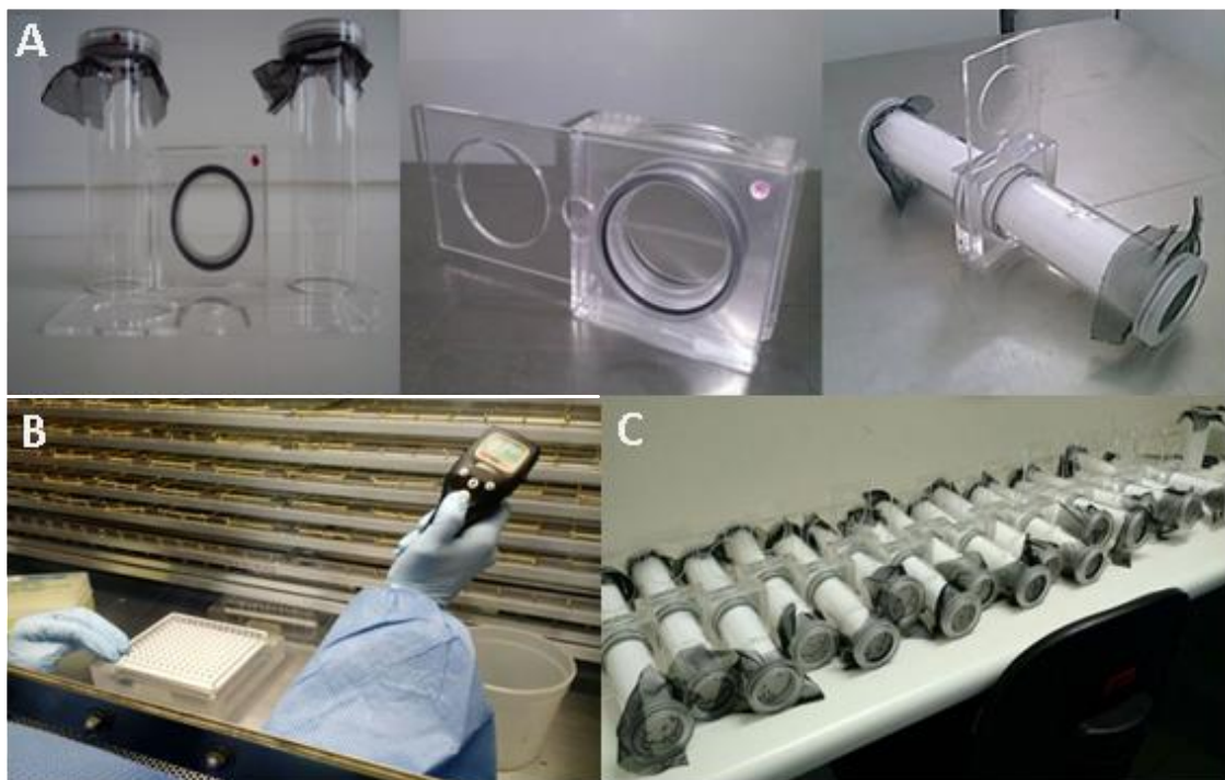
Figura 10. Metodologia adaptada da OMS para avaliação da resistência em adultos de Aedes aegypti . (A) Kit “tipo-OMS”. Detalhes para as partes do kit , o separador móvel entre as câmaras e o kit acoplado. (B) Procedimento de impregnação de papéis. (C) Realização de bioensaio do tipo dose-resposta. Fotografias de Laficave.
