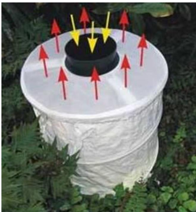
Figura 5: BG-Sentinel. Setas amarelas indicam a sucção pelo funil preto e setas vermelhas indicam a liberação da corrente de convecção de ar. (Fonte: [www.bg-sentinel.com](http://www.bg-sentinel.com)).
