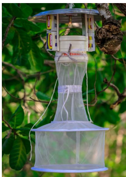
Figura 2: Armadilha luminosa modelo HP: Utilizada para captura de insetos alados, principalmente Flebotomíneos e Dípteros em geral. Fonte: Sousa, RLT
