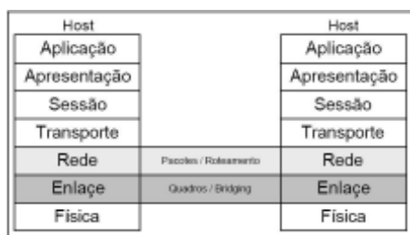
Figura 4: Router e Bridge no modelo ISO/OSI. Fonte: Tanenbaum (1999, p. 99).
