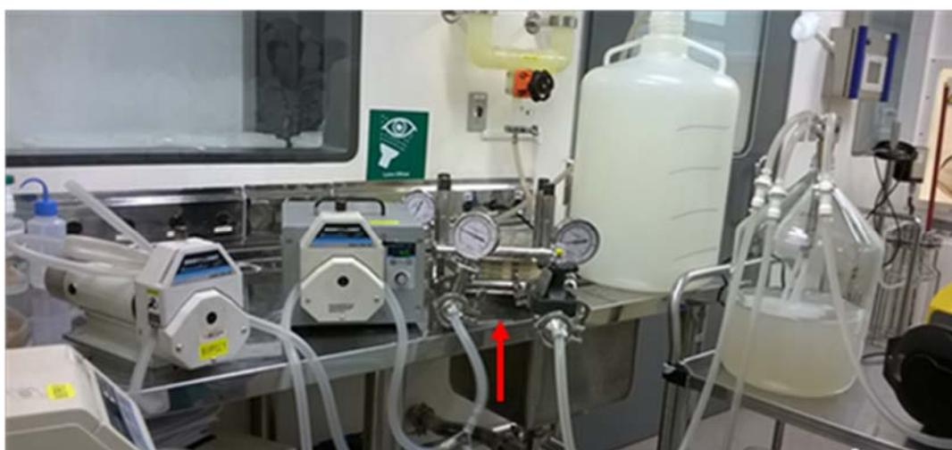
**Figura 31:** Purificação do conjugado na escala industrial. Primeira diafiltração com solução  $\text{Na}_2\text{HPO}_4$  10 mM, pH 10,5 realizada em sistema Centrassette com três membranas com  $0,5 \text{ m}^2$  de área (indicado pela seta).
