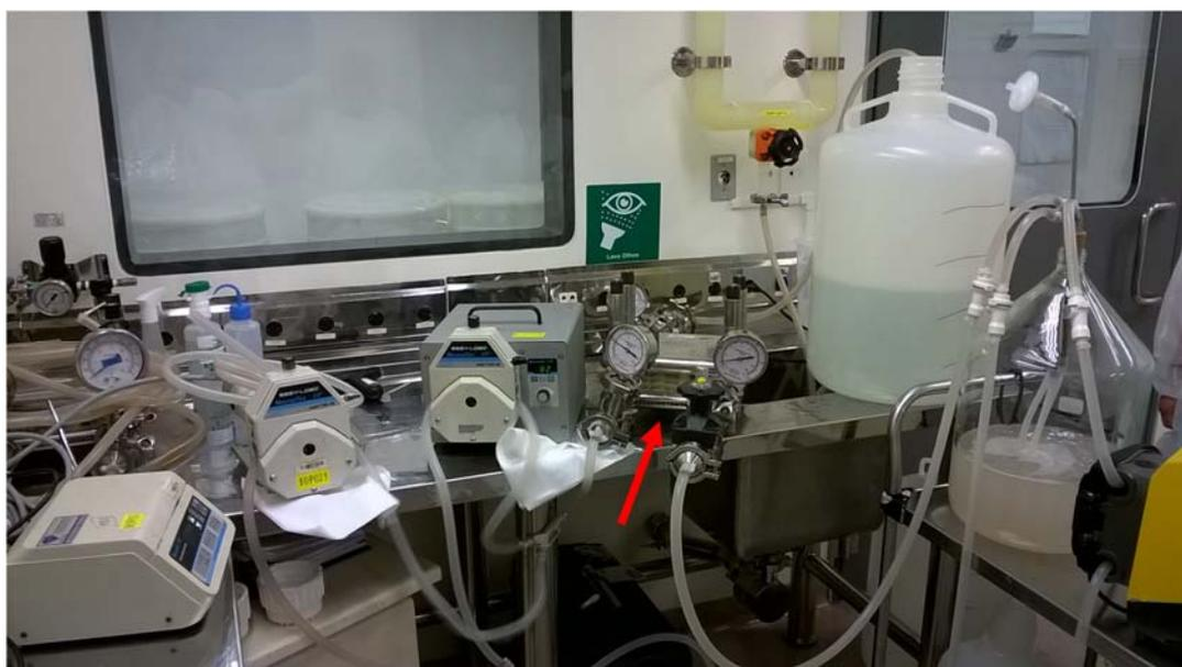
**Figura 32:** Purificação do conjugado na escala industrial. Segunda diafiltração com solução PBS 1,0 mM, pH 7,0 realizada em sistema Centrassette com três membranas de  $0,5 \text{ m}^2$  de área (indicado pela seta).
