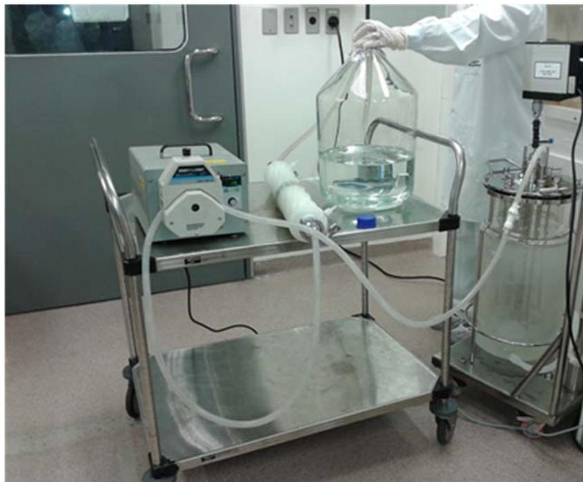
**Figura 26:** Etapa de clarificação do MPCO na escala industrial. O produto é bombeado do reator através da cápsula filtrante com o auxílio da bomba peristáltica e o material clarificado é coletado diretamente em um frasco.
