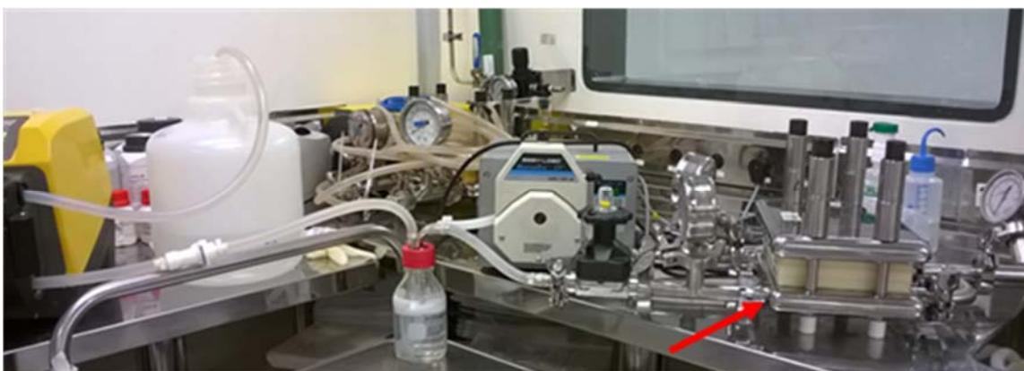
**Figura 27:** Etapa de diafiltração do MPCO na escala industrial realizada em sistema de filtração tangencial Centrassette com três membranas de polietersulfona com  $0,5 \text{ m}^2$  de área filtrante (indicado pela seta).
