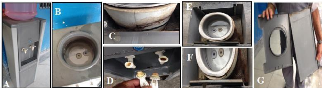
Figura 20. Bebedouro contaminado (amostra 2), antes da higienização. A) Equipamento localizava-se no pátio da unidade escolar. B) Acúmulo de poeira e muita sujeira nas partes internas e externas do suporte que apoiava o garrafão. C) Acúmulo de mofo (presença de fungos) próximo à cuba, após a retirada da tampa externa. D) Torneiras com limo em seu interior. E) e F) Avançado processo de oxidação e presença de insetos (aranhas e suas teias) no suporte da cuba. G) Acúmulo de sujeira e presença de insetos nas partes plásticas.
