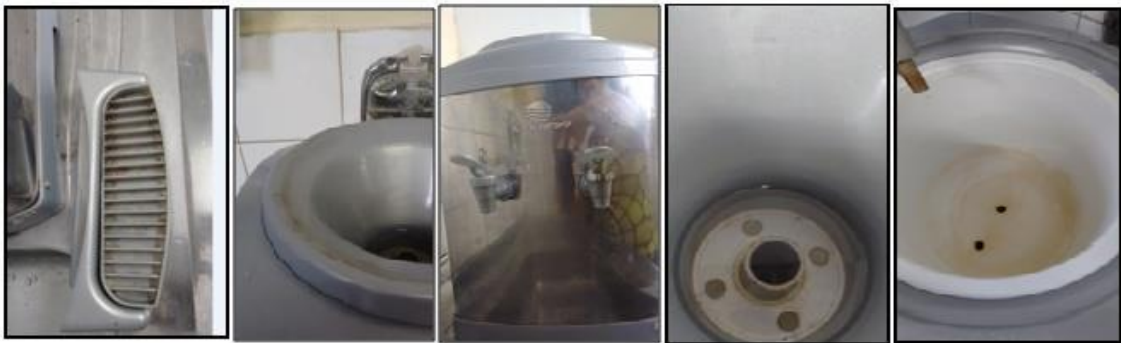
Figura 17. Bebedouro Contaminado. Componentes do bebedouro localizado na sala dos professores antes da higienização. Havia presença de incrustações e limo inclusive nas partes internas que permanecem em contato com a água.
