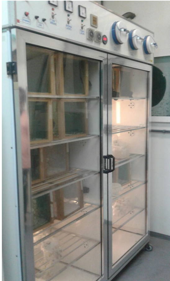
Figura 3: Estante ventilada para criação dos insetos, reguladas a 27 \pm 1^\circ\text{C} e a umidade relativa do ar de 80 \pm 10\% e 12h de fotoperíodo.
