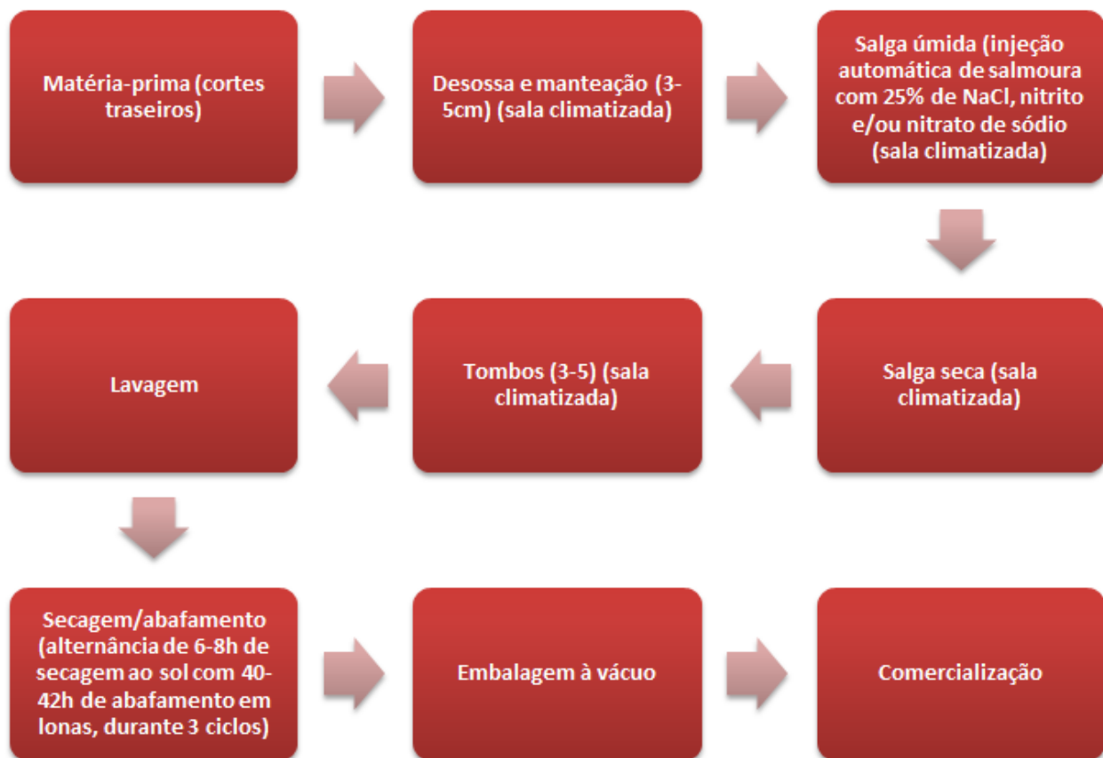
Figura 3 - Fluxograma do processamento tecnológico do jerked beef
