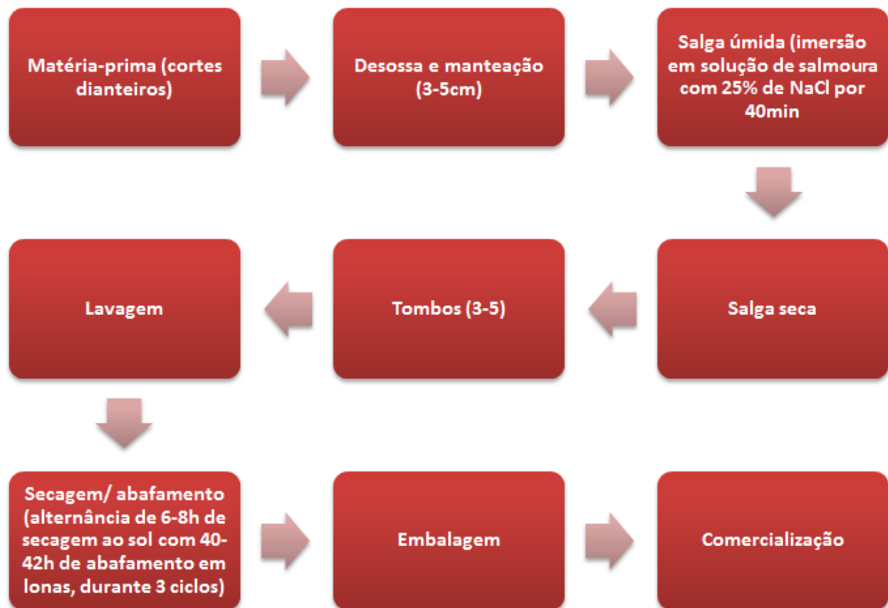
Figura 2 - Fluxograma do processamento tecnológico do charque.
