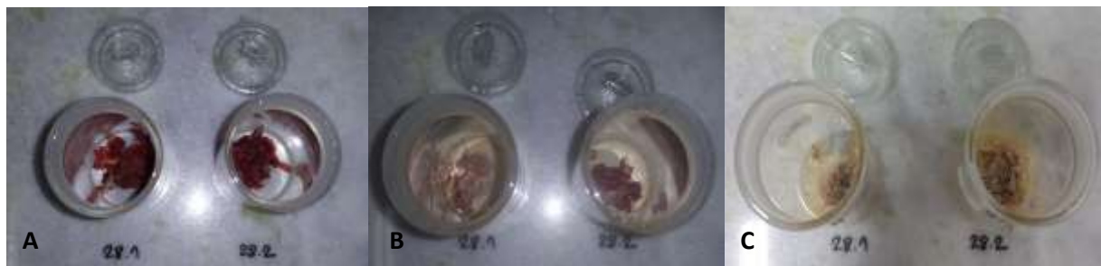
Figura 28 - Amostra nº28 durante a análise do teor de umidade. A) Amostra após pesagem inicial. B) Amostra após 3h de secagem em estufa. C) Amostra após a pesagem final.
