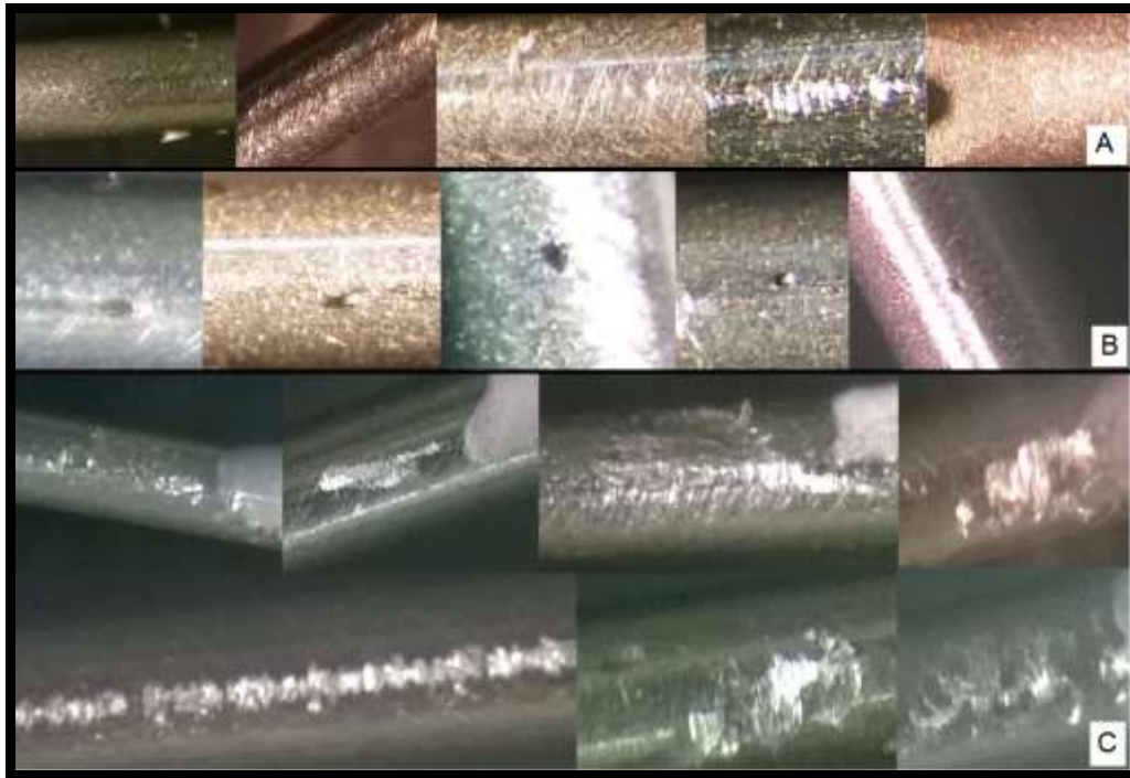
Figura 4. Corrosão grau 2. 4A – Pontos pretos em cânulas de agulhas hipodérmicas. 4B – Desgaste em cânulas de agulhas hipodérmicas. 5C – Diferença de textura em cânulas de agulhas hipodérmicas
