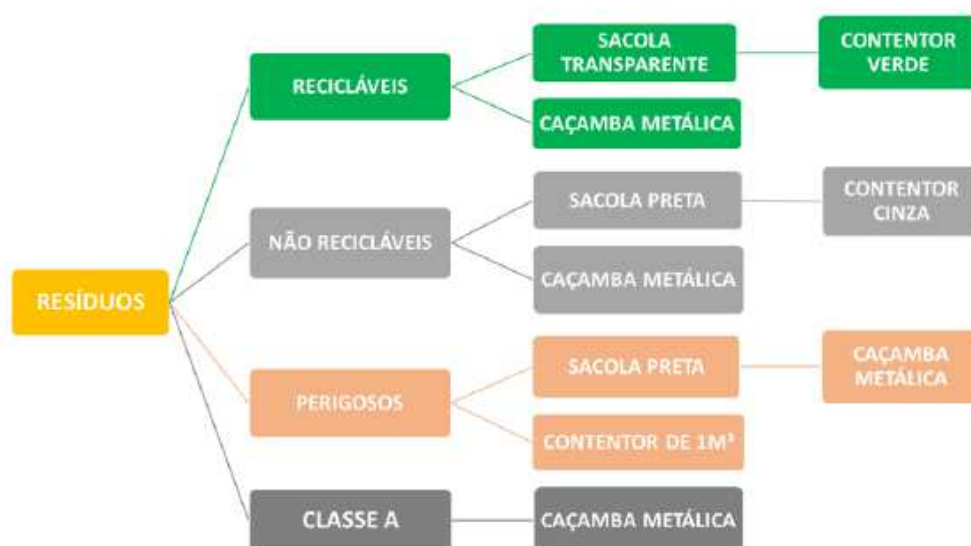
Figura 5 - Fluxograma das etapas de gestão de resíduos nos Terminais de Passageiros - Segregação e Acondicionamento
