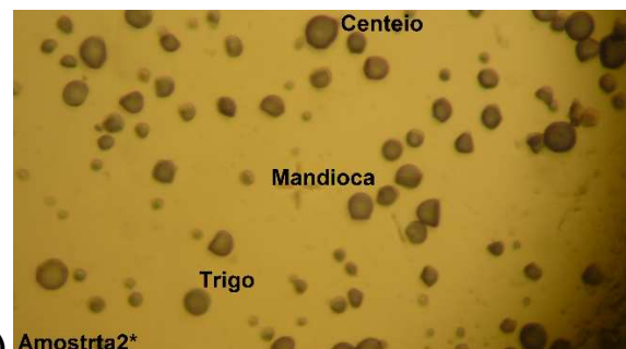
Imagem 31 Amostra 2* (a) aumento 200X com luz polarizada; (b) aumento 200X.
