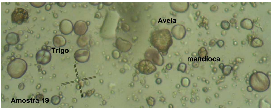
Imagem 19 Amostra 19 aumento 200X com luz polarizada.
