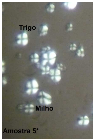
Imagem 34 Amostra 5* aumento 400X com luz polarizada.
