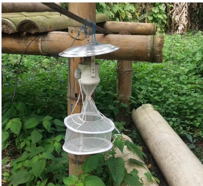
Figura 04: Armadilha de isca luminosa, tipo HP utilizada para coleta vetorial intra e peridomiciliar. Fonte: Arquivo pessoal
