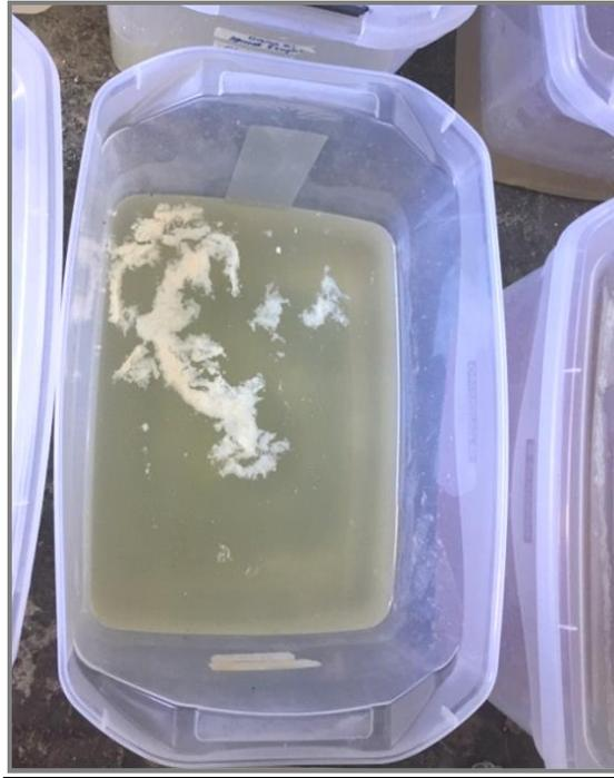
**Figura 9:** Desenvolvimento de material viscoso de cor branca durante o ensaio de janeiro de 2019, recipiente OELE na concentração 280 mg/L com 21 dias de exposição. Nesse recipiente também era observada a alteração de tonalidade do OELE após a exposição em condições simuladas de campo.
