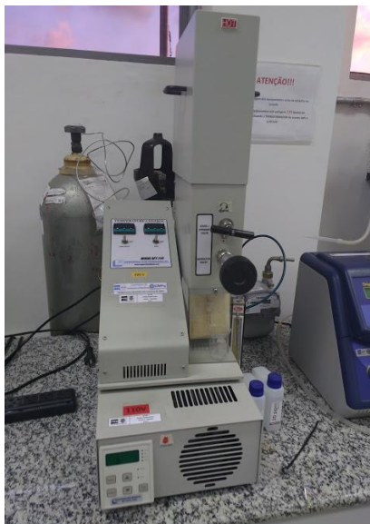
Figura 7 - Unidade de Extração Supercrítica. Equipamento piloto utilizado neste trabalho, SFT-110.
