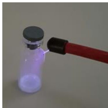
Figura 2 - Demonstração da verificação de vácuo por emissão de centelha elétrica em frasco contendo leite liofilizado.
