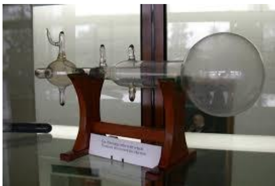
Figura 2 - O tubo de raios catódicos utilizado por Thomson.
