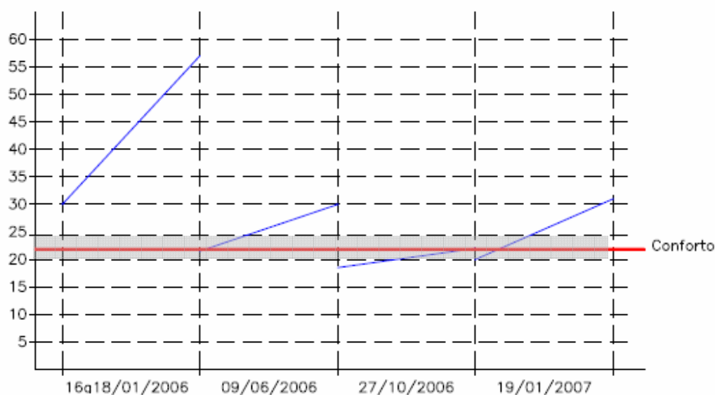
Figura 30: Gráfico do resumo das temperaturas encontradas nas 4 datas, na C2 - HECC
