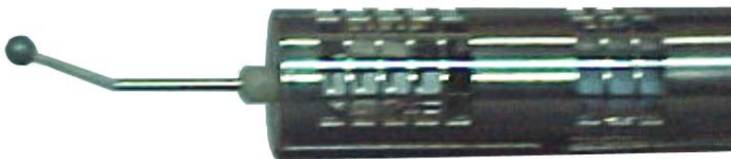
Figura 5.4 – Vista ampliada do sensor para medição de velocidade, temperatura e umidade relativa do ar.
