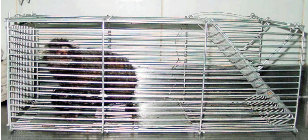
Figura 5: Armadilha modelo Tomahawk (18X18X60cm) utilizada para captura de Callithrix jacchus selvagens no município do Rio de Janeiro, nesta pesquisa.
