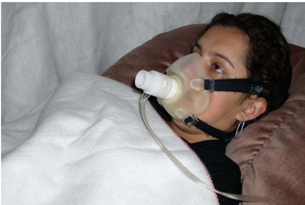
Figura 3. Exemplo de medição da TMB através do VO2000 no estudo de validação (artigo 2).
