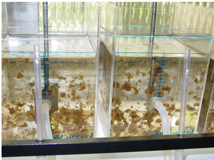
Figura 5.25 – Formação dos flocos com auxiliar de floculação aniônico.
