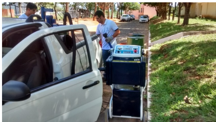
Figura 11 - Tratamento de lâmpadas fluorescentes queimadas Fonte: Arquivo da autora, 2019. Nota: Parceira ICA/UFMG com a Empresa Lax.
