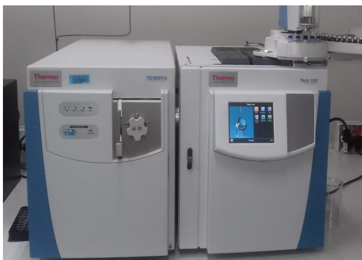
Figura 5: Cromatógrafo GC-MS/MS Triplo Quadrupolo TSQ EVO 8000 (Thermo Fischer Scientific) utilizado para a análise dos agrotóxicos de interesse.
