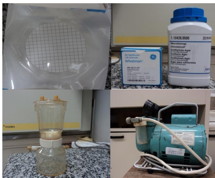
Figura 4 – Equipamentos para a realização da análise bacteriológica: membrana quadriculada, meio de cultura, copo para sistema de filtração, e bomba a vácuo.
