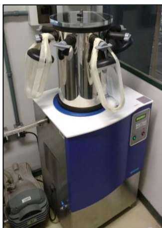
Figura 15 – Instrumento liofilizador para realização do método de concentração de amostras de água por Liofilização.
