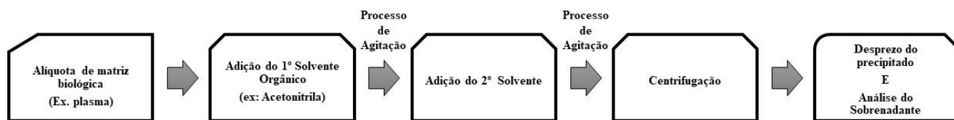
Figura 7: Esquema de precipitação de proteínas de amostras biológicas para análise por CLAE.
