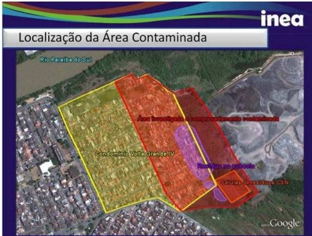
Figura 4- Condomínio Volta Grande IV - Volta Redonda/RJ. Áreas: amarela - Condomínio Volta Grande IV; vermelha - área investigada e comprovadamente contaminada; roxa - resíduo no subsolo; laranja - células de resíduos da CSN. Fonte: BRIGIDA, 2014.
