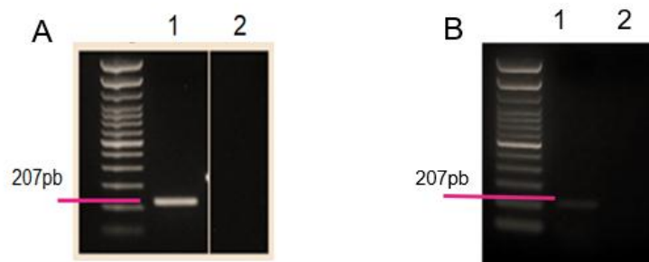
Figura 4.40: PCR com oligonucleotídeo Pol1 com amostras de DNA (A) e cDNA (B) de células Lulo, sendo 2) controle negativo de cada reação
