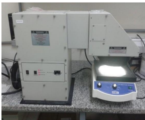
Figura 7 - Foto do Simulador Solar ORIEL/NEWPORT® emitindo Luz Solar Simulada (LSS) e representação esquemática dos seus compartimentos internos
